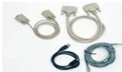
串口线规格：两端为 2、3 交叉，5 线接地。不适用于做硬件流控实验。
