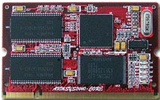
**ARMSYS2440-CORE**核心板，采用 6 层板工艺，具有最佳的电气性能和抗干扰性能。尺寸规格符合 SO-DIMM200 封装标准。多达 200 个引出脚，充分扩展了 S3C2440 的硬件资源，让使用者能够无局限自由地进行底板设计。本产品接受批量和小批量订购，提供全面的技术支持和服务。
